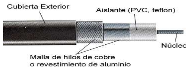
Figura 4.1.2.98 Estructura del cable coaxial.
